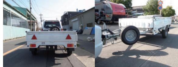
【標準仕様】機械式慣性ブレーキ、サイドブレーキ、ジャッキホイール、ラポートーションアクセル、スペアタイヤ&スペアタイヤマウント & 日本式灯火類
