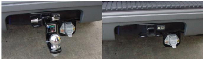
標準装備のアメリカClass II ヒッチの最大許容荷重は3500/300Lbs (1180/136kg) ですので日本のC級規格以上ですが1000kg以上のキャンピングトレーラーをけん引するには不充分ですので当社が常時在庫しているVA社Class III VA82430, VA81702ヒッチメンバーASSYのみ
